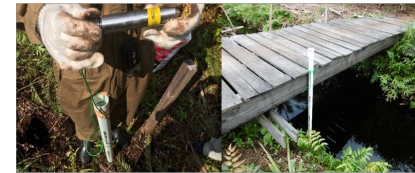
写真 地下水位・排水路の観測
