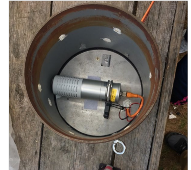
写真 チャンバー内のCO2アナライザー
